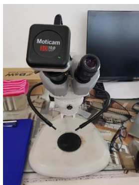
Figura 3.6 - Equipamento utilizado para registro da colmatção (18/06/2020)
