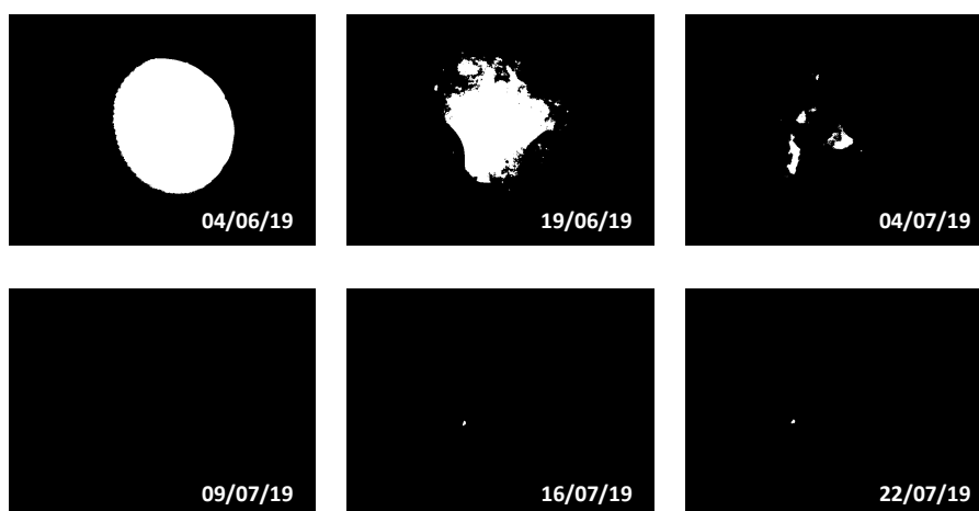
Figura 4.17 - Evolução temporal da colmatação do Furo 2 Placa II Reator 1 (diâmetro 1 mm) durante a segunda etapa visualizada por imagem processada em MATLAB
